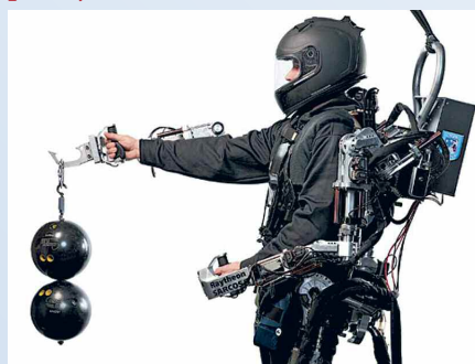
Eksoskelets jeb valkājams robots (XOS) cilvēkam atvieglo ceļšanu un nešanu.
