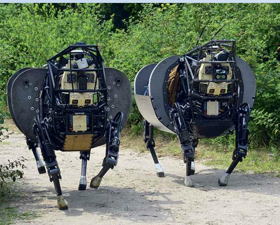
Vismodernākie nesējroboti LS3, kas dod ļoti daudz priekšrocību kaujas laukā, taču pēc testēšanas tie atzīti par pārāk skaļiem, demaskējošiem.
