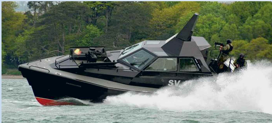
«Barracuda» — paredzēta desantēšanai no helikoptera, ātrums līdz 80 km/h, ložu droša kabīne 10 personām.
