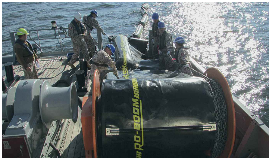
JSF kuģa A-90 «Varonis» komanda nolaiž ūdenī naftu norobežojošās bonas.
