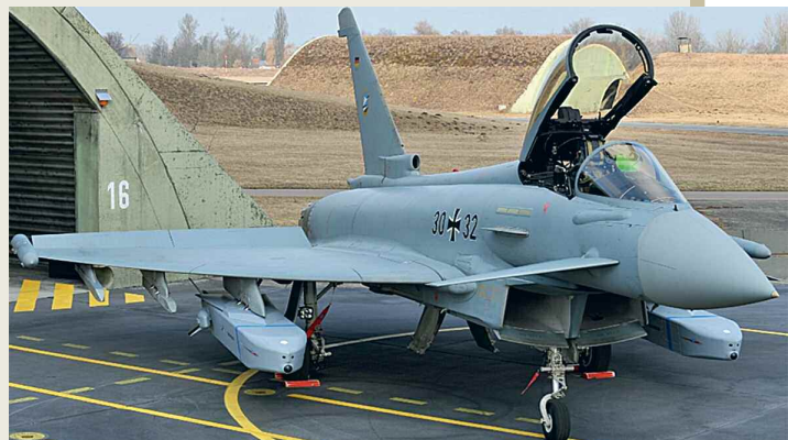
Vācu iznīcinātājs ar divām KEPD 350 tipa raķetēm uz ārējām piekārēm.
