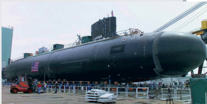
Pirmā «Virginia» tipa zemūdene pēc korpusa būvdarbu pabeigšanas.
